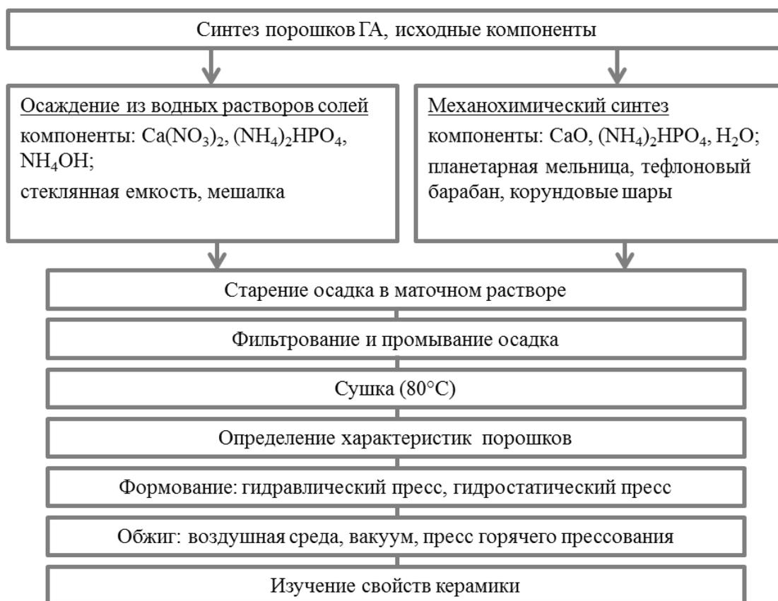
Рис. 2.1.1. Технологическая схема получения ГА-керамики.
